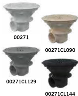
Salida lateral de 2". Cuerpo y rejilla en ABS blanco, con juntas adhesivas, brida y tornillos. Caudal máximo recomendado de 13 m³/h.
