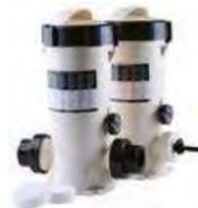
Fabricado en plásticos (ABS). Capacidad aproximada de 3,5 kg de tabletas. Cierre con doble sistema de seguridad en la tapa. Para piscinas de hasta 60 m<sup>3</sup> con cloro y para piscinas de hasta 30 m<sup>3</sup> con bromo.
